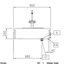
D Drain DO Overflow drain pipe ΕI Electrical inlet (power) EQ Equipotential screw
